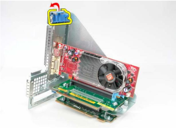
*Figure 5.5.1.4 Riser Cage Latch*
